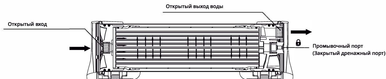
Рис. 2. Принцип фильтрации воды
